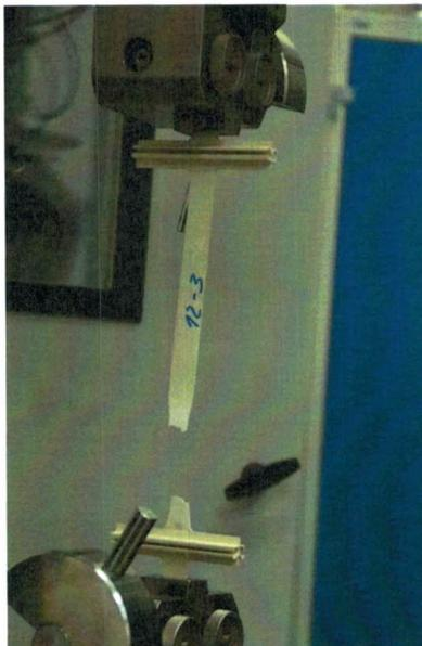
Abbildung 7: Versagen des 12 Inch Konnektor in der freien Länge
