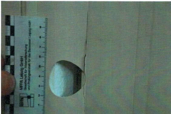
Abbildung 4: lokale Beschädigung in freier Fläche
